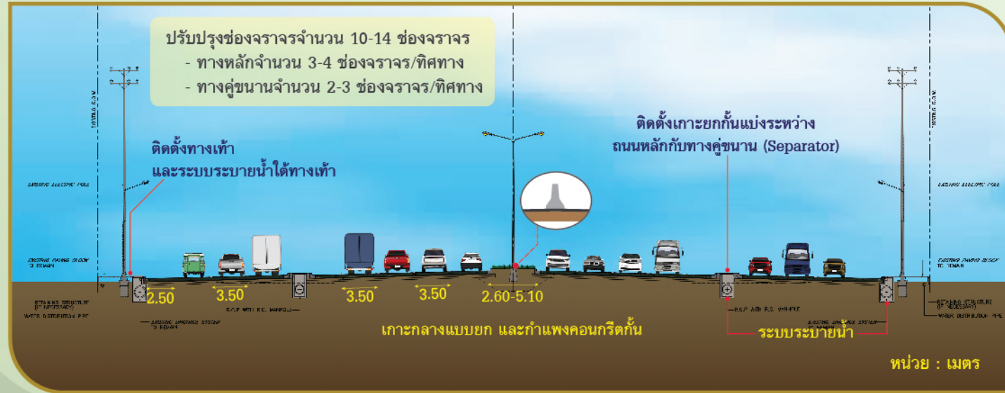
ตัวอย่างรูปแบบหน้าตัดทางหลวงโดยทั่วไปของโครงการ
